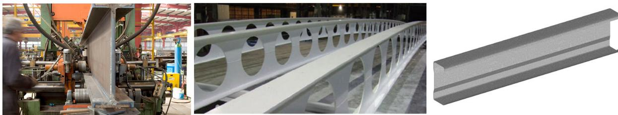
*Esempio di prodotti ricadenti nella EN 1090-1: travi composte saldate, travi alveolari e profili sottili formati a freddo*
